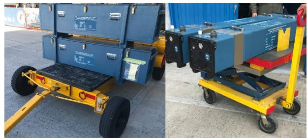
Figura 2. Equipos usados para transporte de municiones
