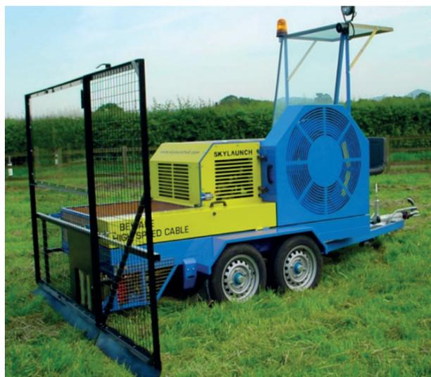
Figura 4. Plataforma de lanzamiento Skylaunch
