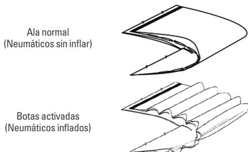
Figura 2. Funcionamiento del sistema neumático en aeronaves
