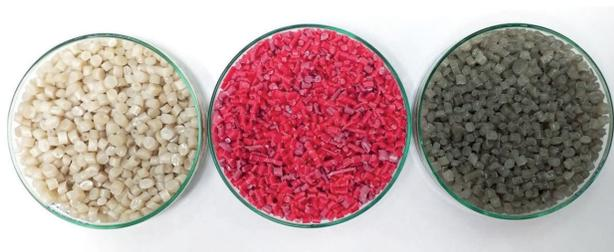
Figura 4. Peletizado de materiales recuperados
