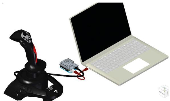
Figura 18. Conexiones entre computador, Arduino UNO y USB Host Shield 2.0 MAX3421E Joystick
