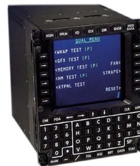
Figura 4. CDU-7000 de Rockwell Collins. Sistema básico ADS-B
