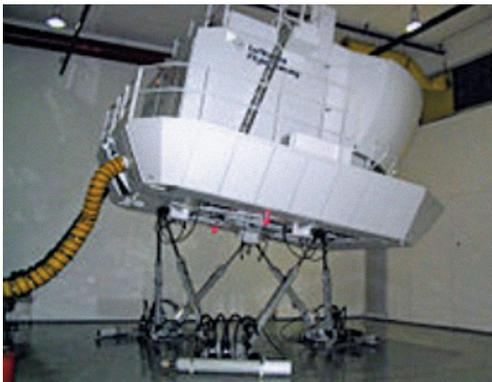
Figura 11. Plataforma Stewart utilizada por Lufthansa
