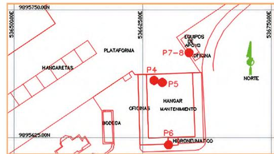
Figura 8. Ubicación de los puntos 4 a 8, con ruido superior a 70 dB en el mantenimiento de aeronaves de combate a turbohélice
