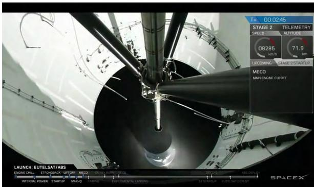
Figura 8. Sistema de separación liberando una de las etapas del cohete Falcon
