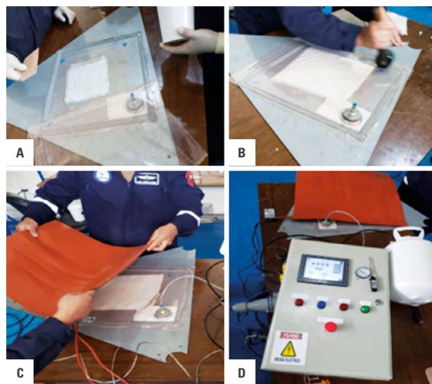
Figura 10. Proceso de laminado y preparación para el curado.
