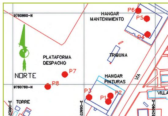
Figura 3. Ubicación de los puntos con ruido superior a 70 dB en el mantenimiento de aeronaves de ala rotatoria
