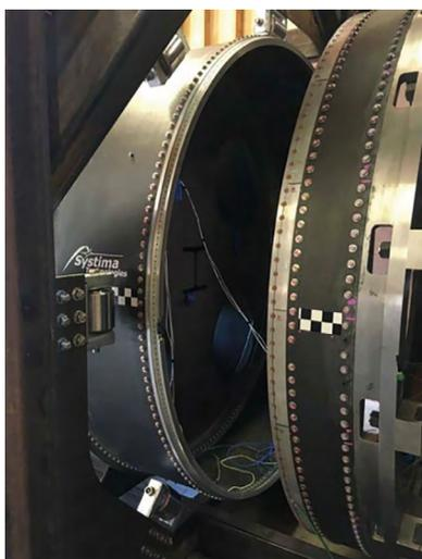
Figura 13. Sistema de separación de etapas para Firefly Aerospace
