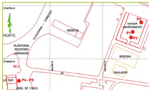
Figura 5. Ubicación de los puntos con ruido superior a 70 dB en el mantenimiento de aeronaves supersónicas
