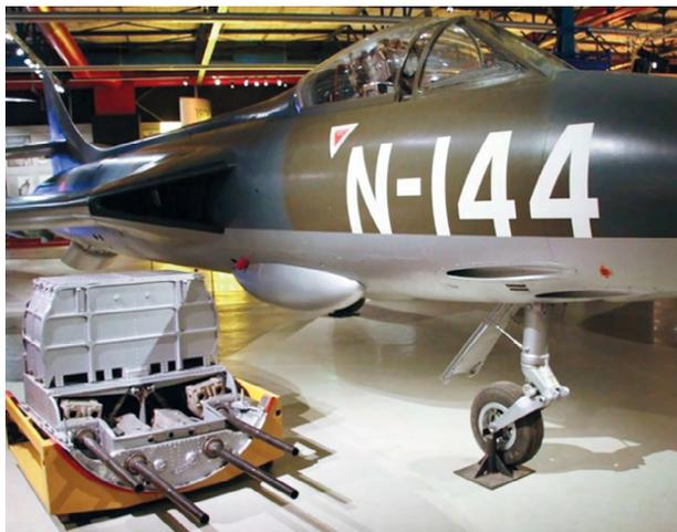
Figura 12. Paquete removible de cañones de 30 mm ADEN, instalado en Hawker Hunter F.4 (N-144)
