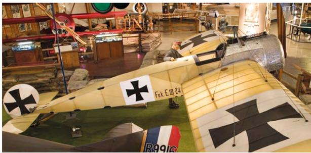
Figura 4. Aeronave Fokker E-III Eindecker con ametralladora de hélice
