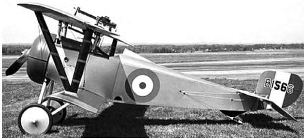
Figura 2. Aeronave Nieuport 17 con ametralladora en el plano superior
