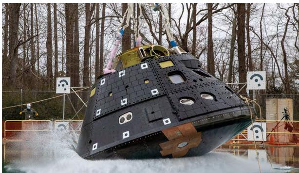
Figura 3. Pruebas a la cápsula Orión
