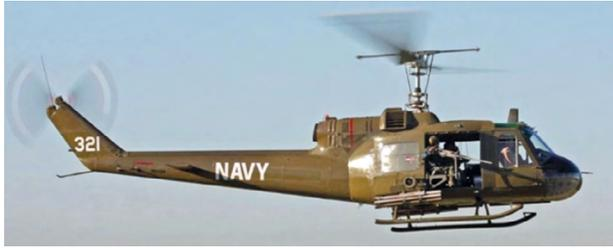
Figura 17. Helicóptero Bell Model Bell UH-1B
