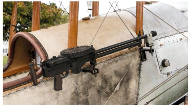
Figura 1. Aeronave Bristol Scout con ametralladora direccionada lateralmente
