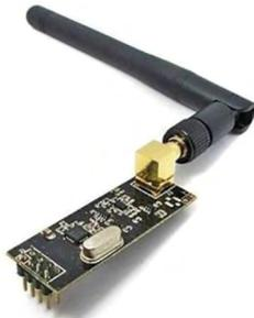
Figura 8. Módulo transceptor nRF24L01
