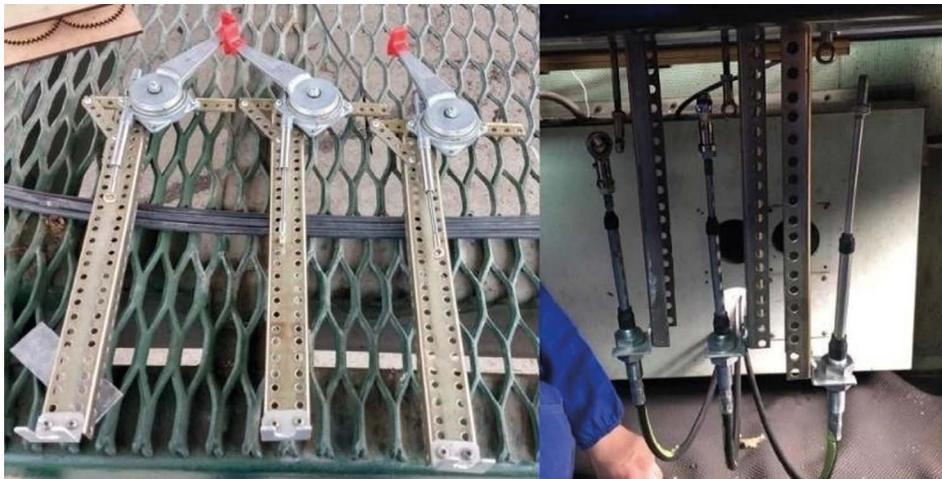
Figura 9. Fijación de los cables de control mecánico a las palancas de control
