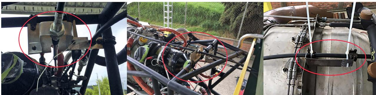
Figura 6. Pasamuros de fijación en el motor
