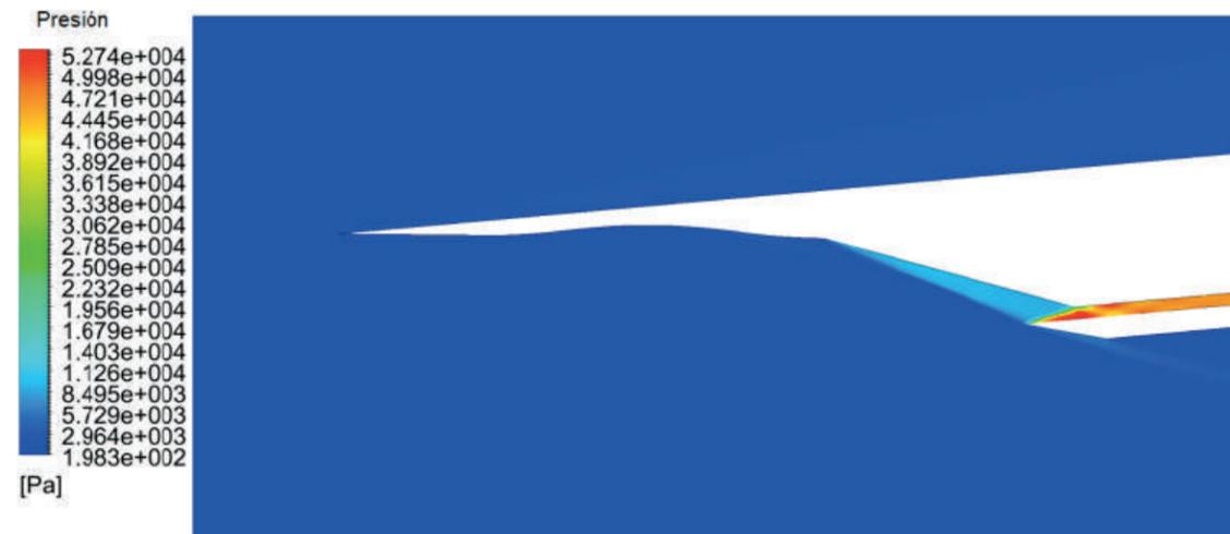
Figura 14. Detalle de presión-Configuración 5 (-5°).
