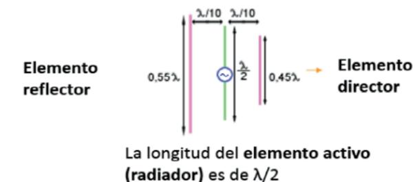
Figura 4. Cálculos para el diseño de antena Yagi-Uda
