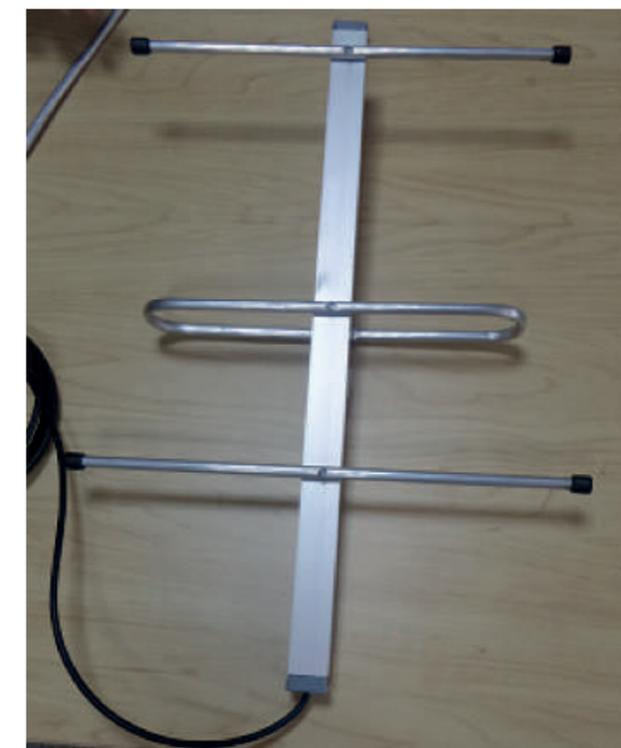
Figura 5. Prototipo antena Yagi-Uda diseñada.
