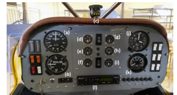
Figura 5. Panel de Instrumentos Aeronave WA500-AG. (a)Velocímetro, (b)Variómetro, (c) Brújula magnética, (d) Indicador Temp. Agua. Motor, (e)Indicador Temp. Aceite, (f) Indicador Presión. Aceite, (g) Indicador Presión. Combustible, (h) EGT, (i) Amperímetro, (j) Altimetro, (k) Tacómetro, (l) Radio VHF. Fuente: elaboración propia.
