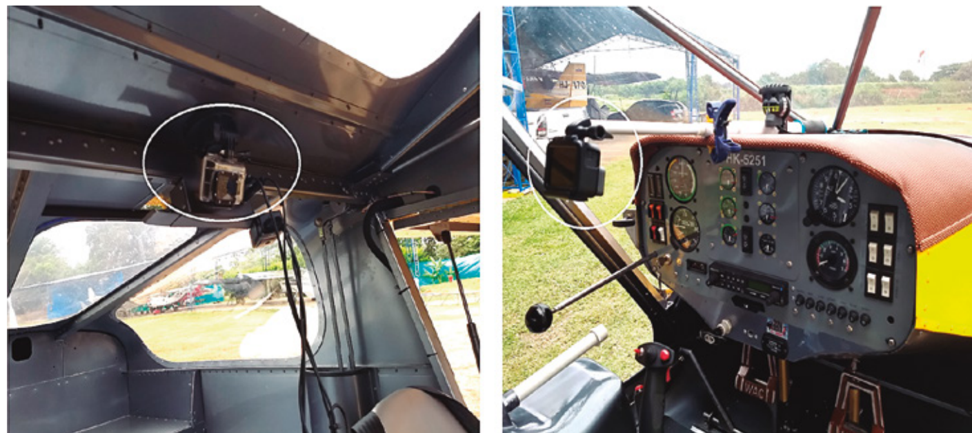
Figura 9. Detalle de instalación de las cámaras en cabina de vuelo. Fuente: Elaboración propia.
