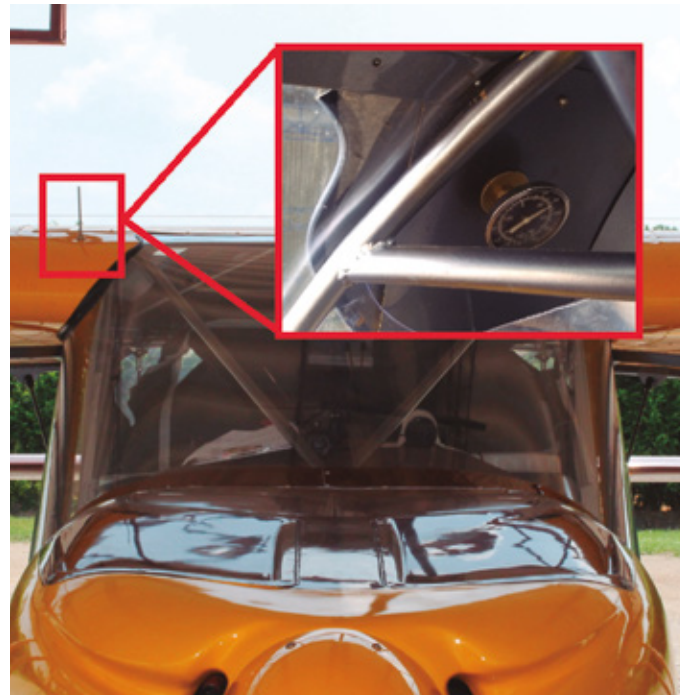
Figura 6. Instalación del medidor de temperatura ambiente (OAT - Outside Air Temperature) Fuente: elaboración propia.
