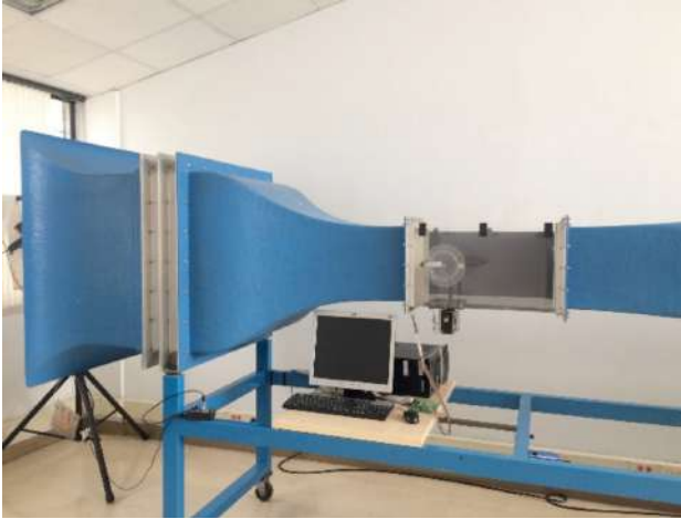
Figura 1. Sección de prueba del túnel de viento Fuente: elaboración propia
