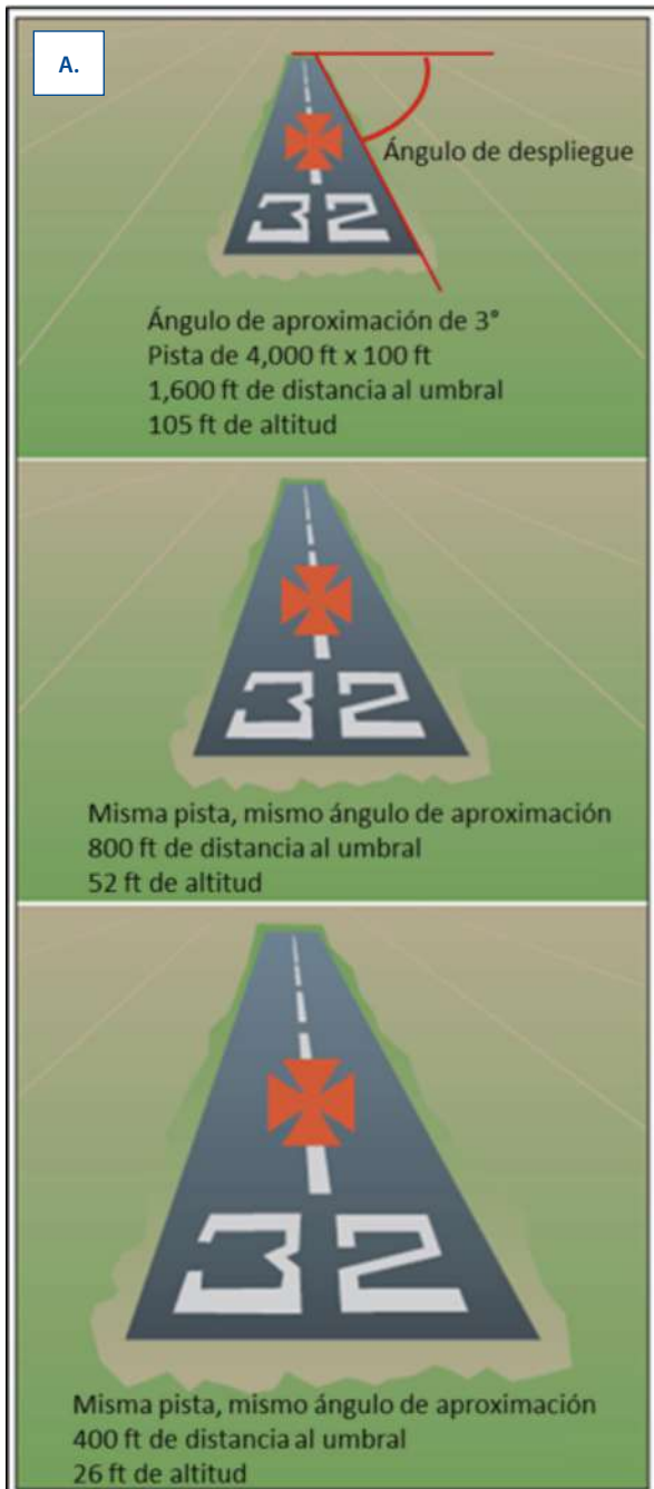
Figura 10. Concepto de “despliegue”. La figura (A) ilustra una trayectoria de planeo constante durante la fase de aproximación, el despliegue permanece constante en diferentes altitudes y distancias con referencia al umbral de pista y permite una aproximación estabilizada mediante el uso de referencias visuales. En contraste, la figura (B) describe tres escenarios diferentes donde el despliegue difiere y la combinación de altitud y distancia conlleva a ángulos de aproximación diferentes
