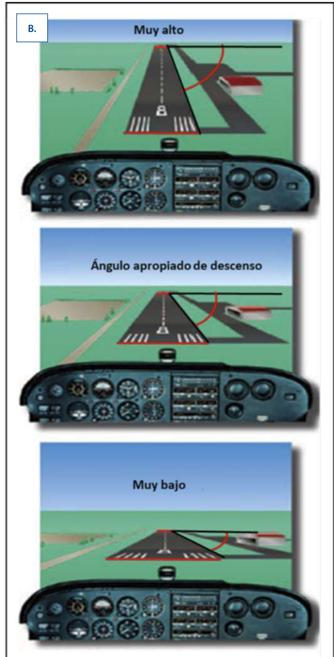
Figura 10. Concepto de “despliegue”. La figura (A) ilustra una trayectoria de planeo constante durante la fase de aproximación, el despliegue permanece constante en diferentes altitudes y distancias con referencia al umbral de pista y permite una aproximación estabilizada mediante el uso de referencias visuales. En contraste, la figura (B) describe tres escenarios diferentes donde el despliegue difiere y la combinación de altitud y distancia conlleva a ángulos de aproximación diferentes
