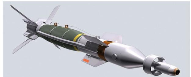
Figura 1. Kit de guiado GBU-49 para bomba MK-82
