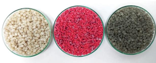
Figura 4. Peletizado de materiales recuperados
