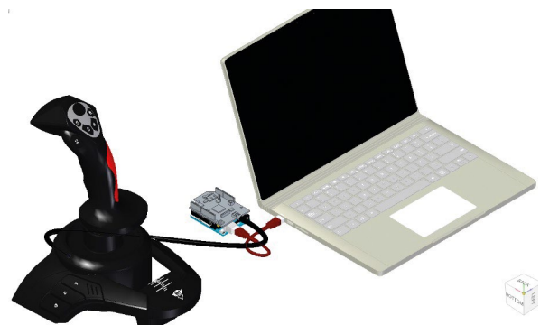
Figura 18. Conexiones entre computador, Arduino UNO y USB Host Shield 2.0 MAX3421E Joystick Fuente: elaboración propia.
