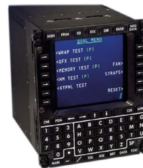
Figura 4. CDU-7000 de Rockwell Collins. Sistema básico ADS-B Fuente: tomado de Southeast Aerospace (2008).
