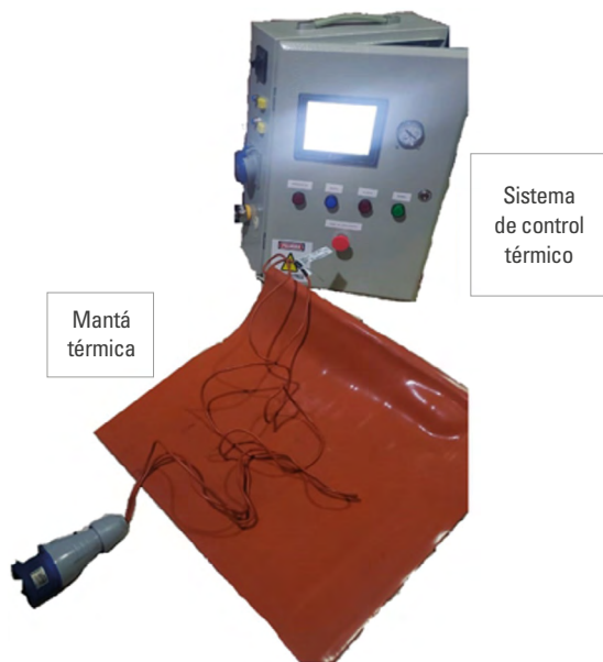
Figura 6. Esquema general del sistema térmico Nota: Principales componentes del subsistema térmico. Fuente: elaboración propia.
