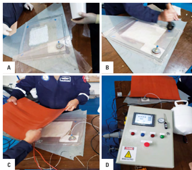
Figura 10. Proceso de laminado y preparación para el curado. A) Laminación. B) Sellado y enfundado. C) Colocación de mantas térmicas. D) Programación del curado en la maleta de curado automático
