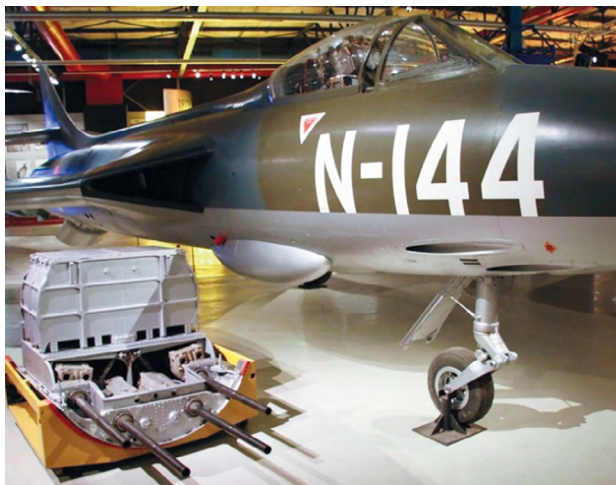
Figura 12. Paquete removible de cañones de 30 mm ADEN, instalado en Hawker Hunter F.4 (N-144) Fuente: Wageningen (2008).
