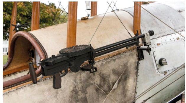
Figura 1. Aeronave Bristol Scout con ametralladora direccionada lateralmente
