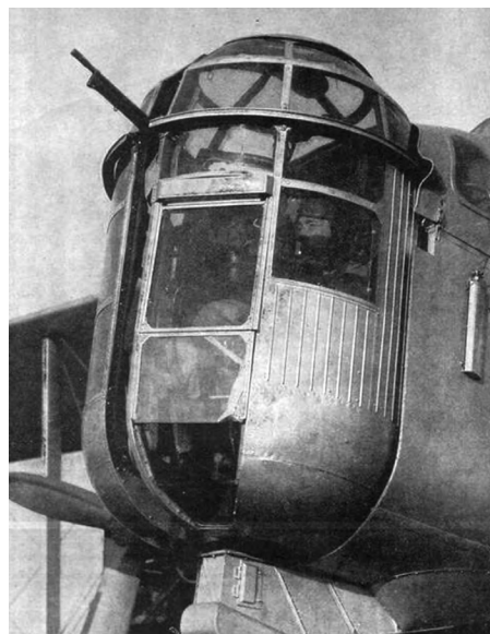
Figura 8. Torreta de cañón Paul Boulton Overstrand Fuente: Richard (2009).
