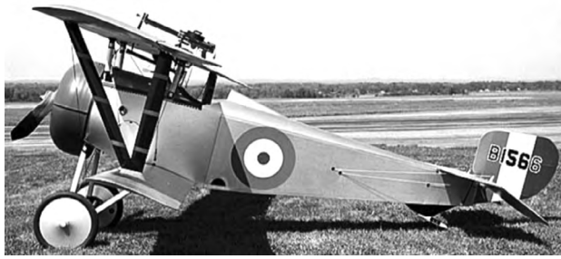
Figura 2. Aeronave Neieuport 17 con ametralladora en el plano superior Fuente: SilverHawkAuthor (2020).
