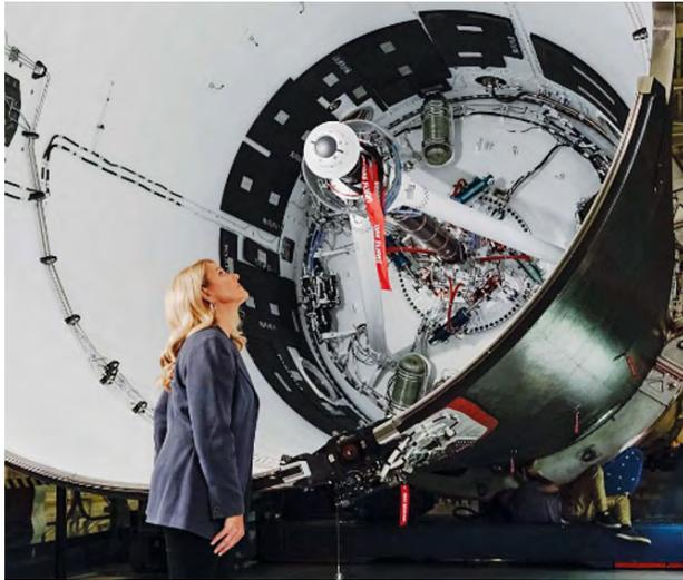
Figura 7. Sistema de separación de etapas montado en un cohete Falcon
