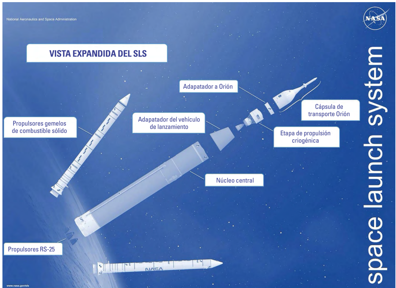
Figura 2. Sistema de lanzamiento espacial (SLS) Fuente: imagen modificada por los autores con base en Mohon (2020).
