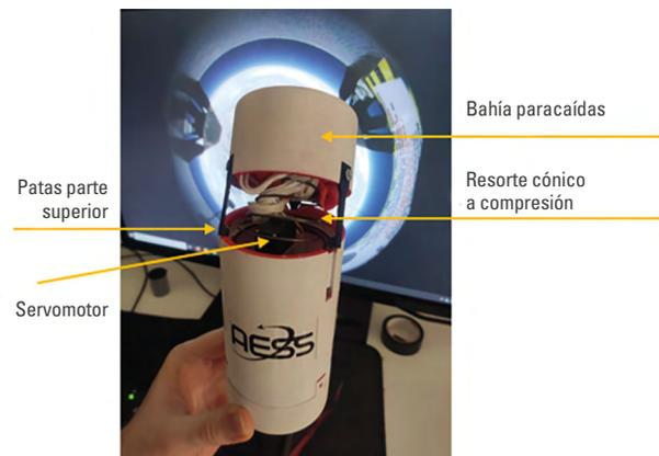
Figura 12. Sistema de eyección de paracaídas ensamblado
