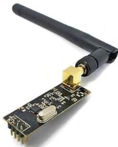
Figura 8. Módulo transceptor nRF24L01
