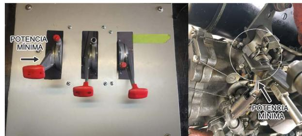
Figura 12. Palancas de potencia y potencia mínima
