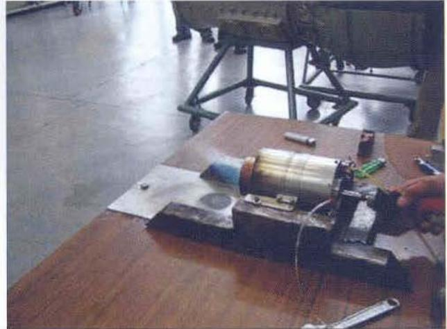
Figura 12. Pruebas de encendido finales
