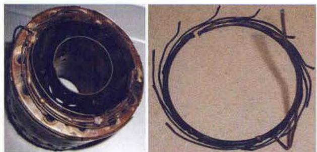
Figura 6. Cámara de combustión ensamblada e inyectores
