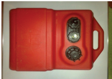
Fig. 26. Tanque de combustible
