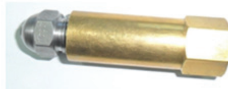
Fig. 29. Boquilla o inyector tipo simplex 2,7GPH @ 100psi con conos de aspersión sólidos de 30° 45° y 60°
