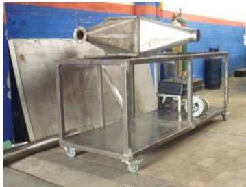
Fig. 67. Adecuación de Bancada con Intercambiador de calor y sistema de lubricación
