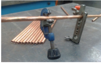
Fig. 41. Tubería de cobre Tipo K y Herramientas de Corte
