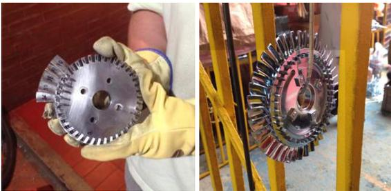
Figura 11. Conjunto rotor de la turbina libre
