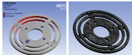
Figura 9. Soportes fijos en los anillos retenedores y enmallado
