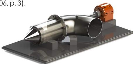
Figura 7. Modelamiento de la turbina libre
