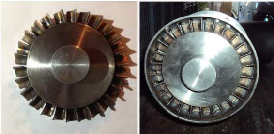
Figura 12. Conjunto estator de la turbina libre
