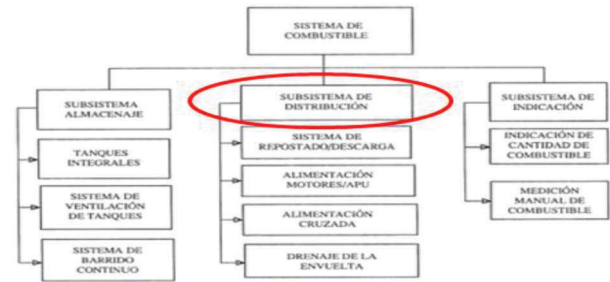
Figura 5. Esquema sistema de combustible aviación general Fuente: Gato (2011).
