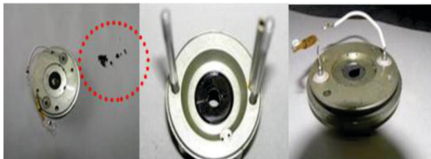
Figura 3. Vista interna de la sección eléctrica bomba de combustible P/N 1C15-7
