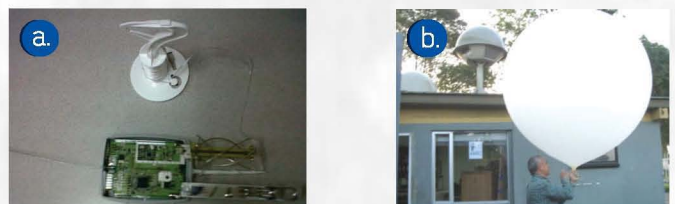
Figura 1. (a) Interior radiosonda marca Vaisala; (b) Globo meteorológico y antena de estación en tierra
