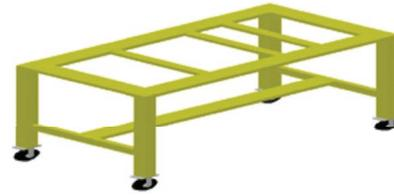
Figura 2. Diseño en AUTO CAD de la estructura del banco de trabajo N1 que soporta las cajas de (42° y 90°).
