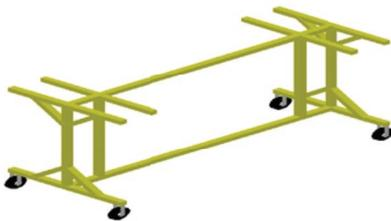
Figura 5. Diseño en AUTO CAD de la estructura del banco de trabajo N2 que soportan los ejes y hangers.
