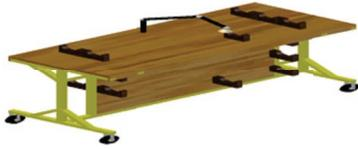
Figura 4. Diseño en AUTO CAD banco de trabajo N2 para realizar inspección mantenimiento y almacenamiento de ejes y hangers.
