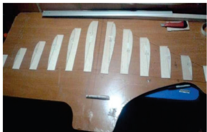
Figura 19. Alineación de Jigs Fuente: Bogotá, Colombia; Autores
