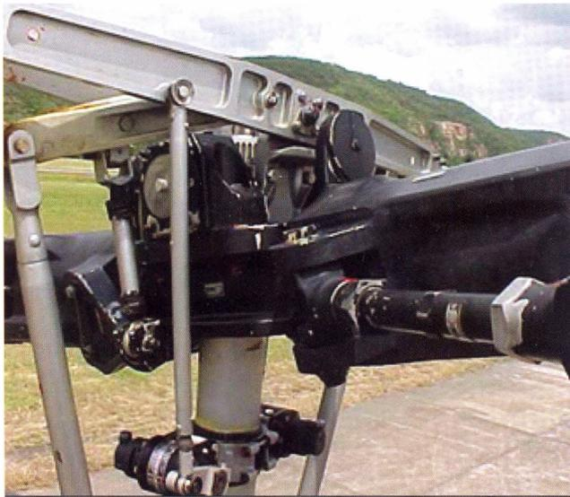
Foto 1. Rotor de helicóptero.
