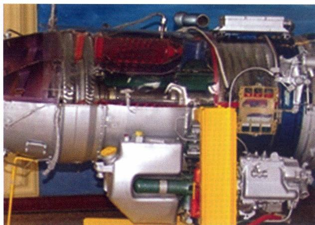
Foto 2. Vista transversal del motor J85
