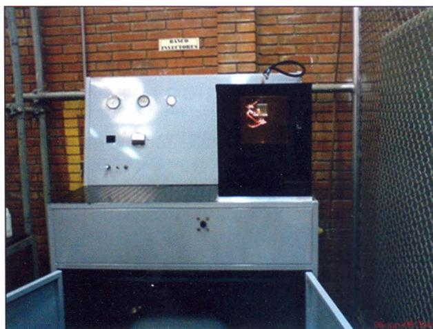
Foto 6. Banco de prueba de inyectores
