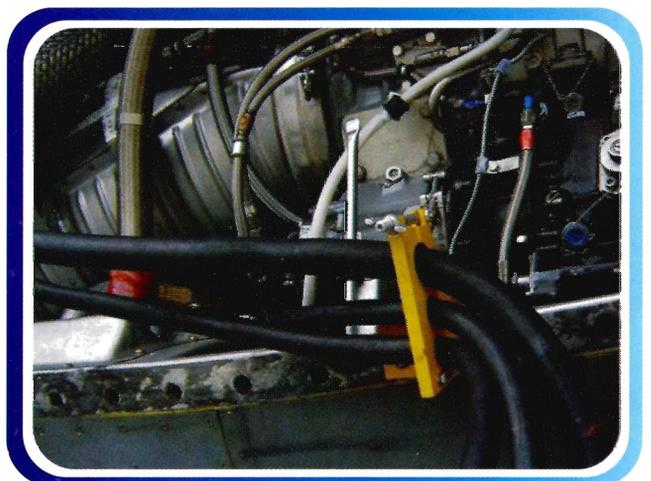
Con las medidas ya tomadas el siguiente paso fue soldar todas las piezas y abrir los agujeros para los pernos, los fleches con los que va sujeta la herramienta a la estructura se consiguieron en la base de CATAM, los cuales tenían que ser los mismos que utiliza el avión c-130 en sus tapas del motor.
