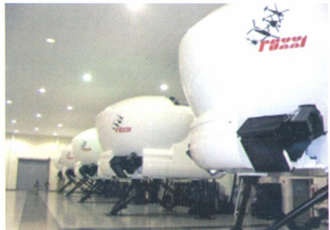
Figura 16. Plataformas de Stewart utilizadas en simuladores de vuelo [15].
