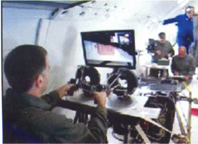
Figura 12. Dispositivos Hápticos o de realimentación de fuerza, dan mayor sensación de realidad a los controles de un simulador de vuelo [11].
