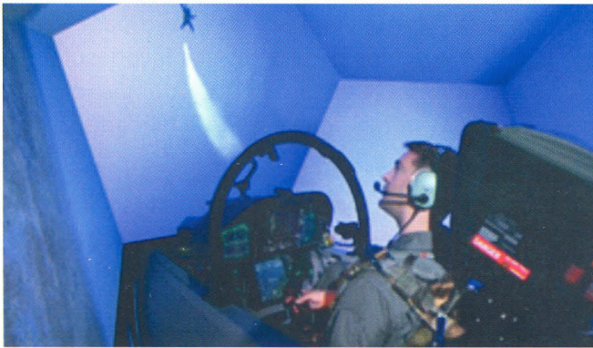
Figura 15. Sistemas de visualización tipo CAVE para simuladores de vuelo. [14]
