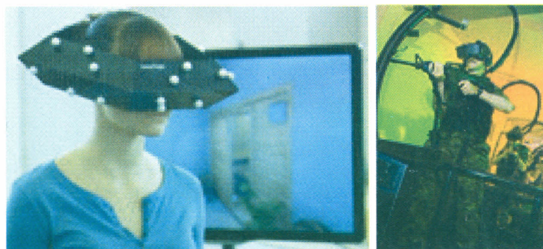
Figura 11. Sistemas de seguimiento de cabeza tracking IR para dar una sensación de inmersión en la simulación [10].
