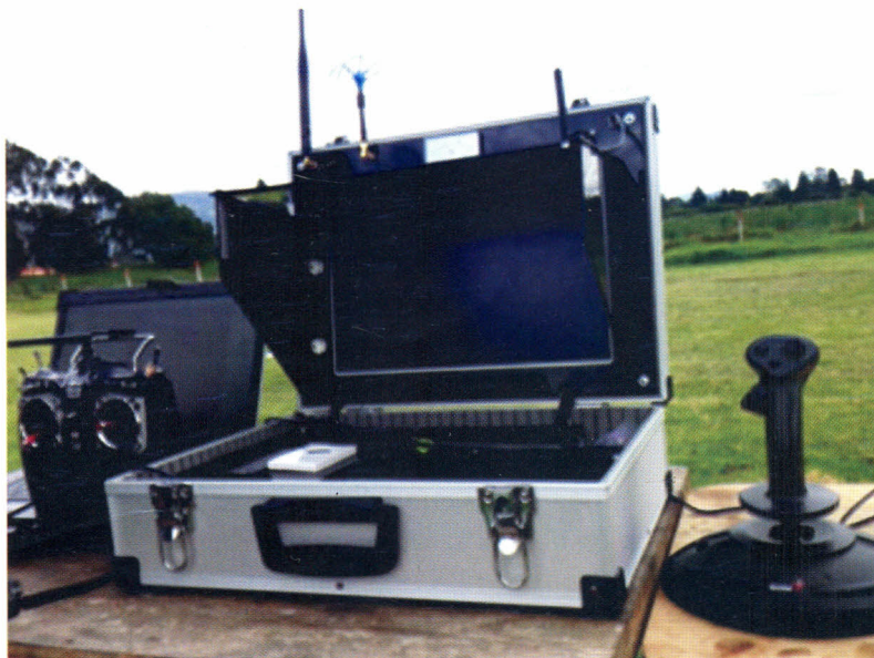
Figura 1. Estación de control en tierra para una aeronave no tripulada de corto alcance.
