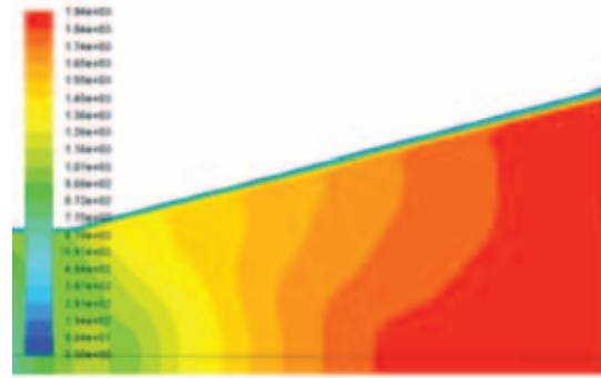
Figura 14. Distribución de la velocidad en la parte divergente y capa limite en la pared
