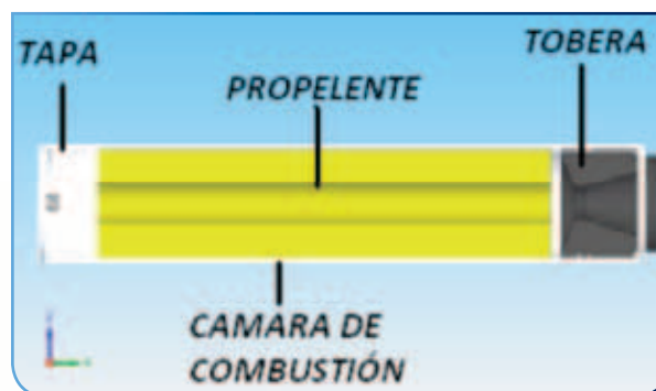
Figura 1. Partes del motor cohete de propelente sólido.
