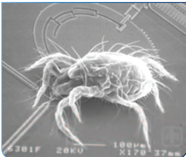
Figura 4. Comparación del tamaño de un acaro de polvo con la estructura de un sistema micro electromecánico MEMS.
