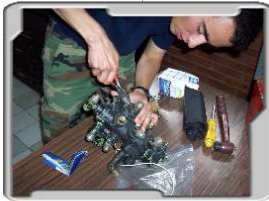
INSPECCION DE LA VALVULA DISTRIBUIDORA
