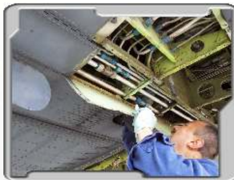
DESMONTE DE LA VALVULA DISTRIBUIDORA DEL AVION
