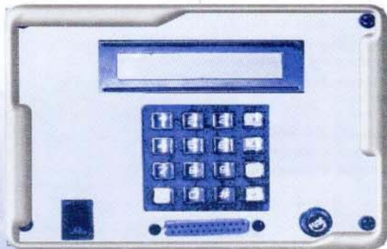
Banco digital para probar el funcionamiento del master caution.
