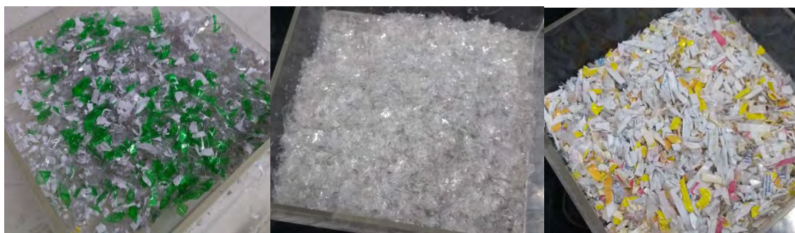
Fig. 46. Resultados proceso de triturado. a) PET. b) PP. c) PS.
