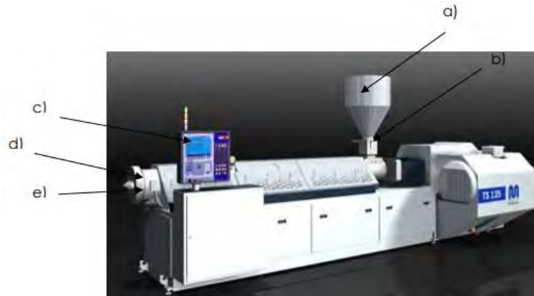
Fig. 10. Maquina Extrusora Battenfel BEX-90 y sus partes. [35]
