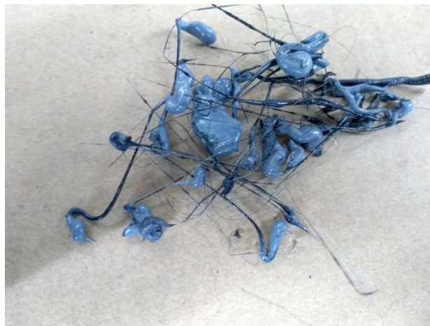
Fig. 47. Resultados de extrusión de RPET.
