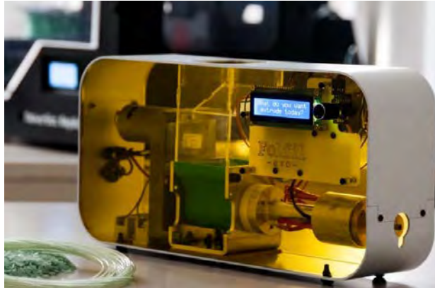
Fig. 2. Ilustración del sistema de extrusión Felfil EVO. [10]
